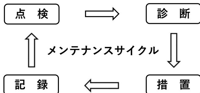
これらを踏まえて、今後さらに、老朽化する道路構造物の増加が見込まれることから、下記の定期点検要領に基づき、5年に1回の頻度で近接目視による点検を実施し、健全性の判定を4段階で区分して構造物の状態を把握していく。
